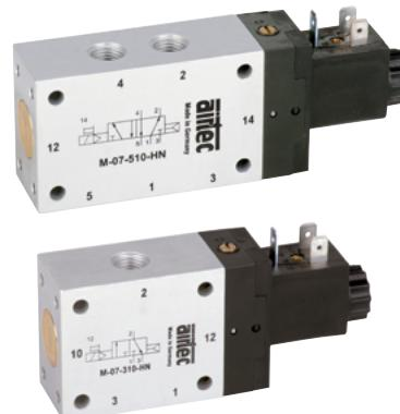
Elektrisch betätigtes Kolbenschieber-Ventil. Nach Zuschalten der Spannung wird das Ventil umgesteuert. Die Ventile sind mit einer rastenden Handhilfsbetätigung ausgestattet. Die Betätigung erfolgt mittels Schraubendreher.
