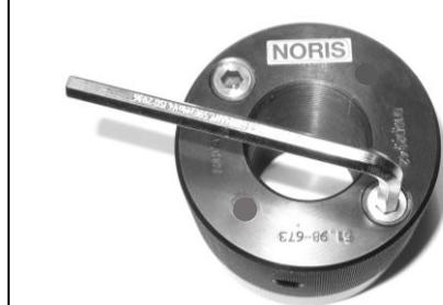
Der mitgelieferte Stiftschlüssel wird verwendet, um die Druckschrauben in den Mutternkörper einzudrehen. Das Medium fließt in die planseitig vorhandene Ringnut und bewegt die Nutringdichtung und den Ringkolben.
