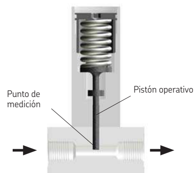
Presostato, punto de medición bañado
